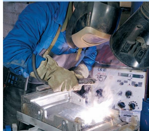
■ *Konstruktionsschweißung mit Lost Foam-Bauteilen*
