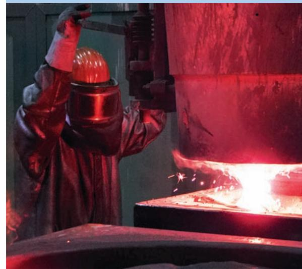
■ *Abguss mit einer Stahlschmelze*
