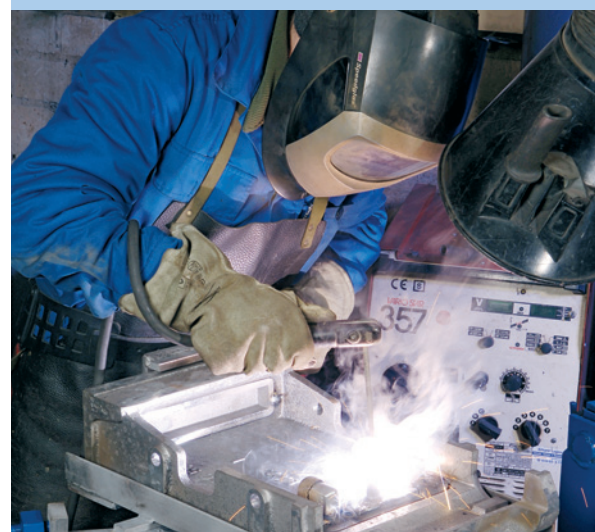
■ Konstruktionsschweißung mit Lost Foam-Bauteilen
